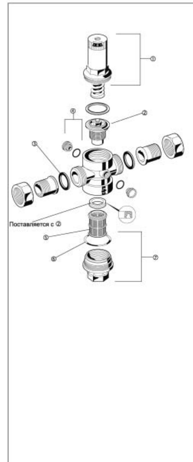
Запасные части для клапанов с понижением давления D 06 F
